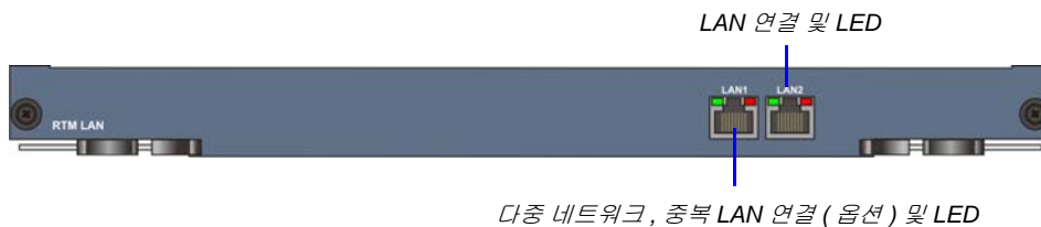
그림 1-4 RMX 2000 RTM LAN 뒷면 패널 레이아웃
